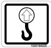
Fig. 7: Placa ojete de soporte
