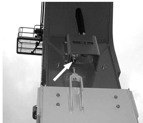
Figura 2-6. Interruptor limitador horizontal de la pluma de torre
