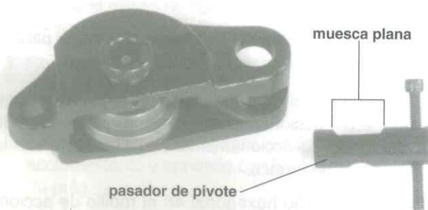
Figura 19 – Posición correcta del pasador de pivote
