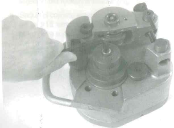
Figura 8 – Extracción del tornillo hexagonal fuera del rodillo de accionamiento
