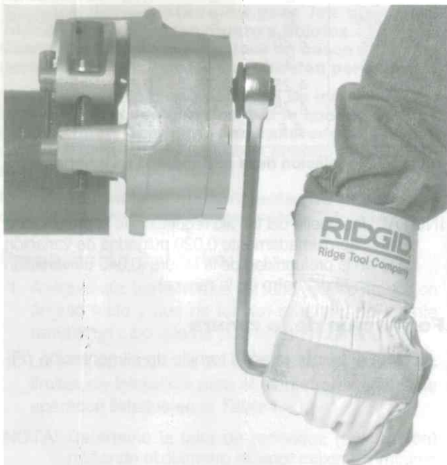
Figura 6 – Ranurado de un tubo
