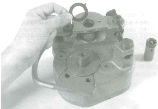
Figura 10 – Colocación de la arandela de empuje con lengüeta
