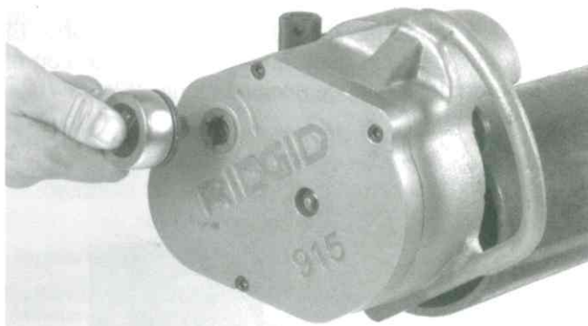
Figura 7 – Trinquete en la entrada de la transmisión
