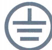
Imagen 24 - Toma de tierra
