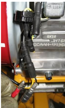
1 DESCONECTAR EL CABLE NEGRO DE LA BUJÍA
