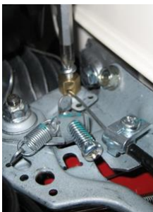
3 FIJAR LA SIRGA DEL ACELERADOR
