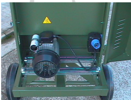
Fig. 2.2. Montaje del motor eléctrico.
