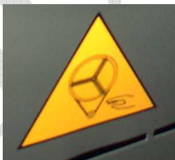
Pictograma de peligro de atrapamiento entre poleas y correa de transmisión
