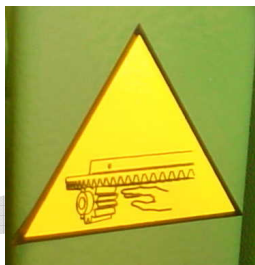
Pictograma de peligro de atrapamiento (2) a ambos lados del resguardo del piñón
