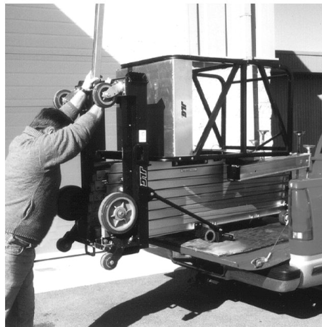
Figura 4-11. Carga de la máquina sobre la cama de una camioneta.
