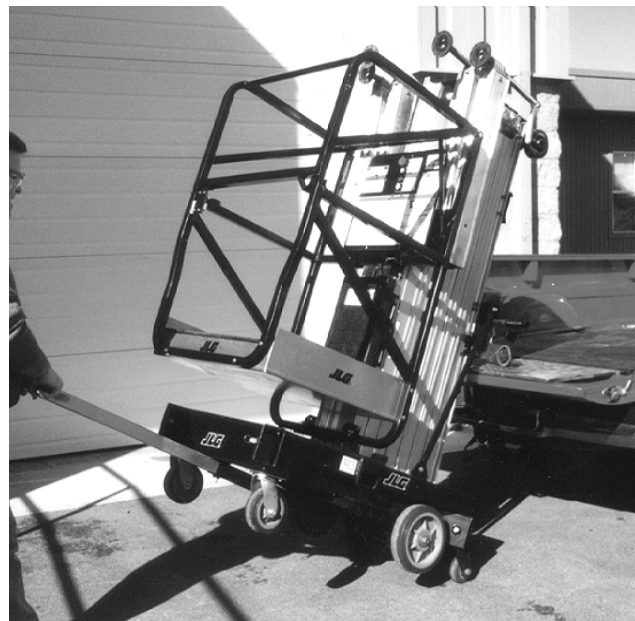
Figura 4-11. Carga de la máquina sobre la cama de una camioneta.
